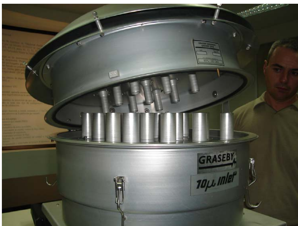
Cabezal separador de partículas menores de 10 micrones.
